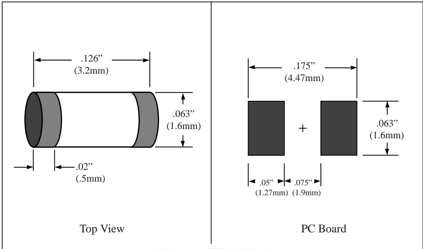
Tolerance  $\pm .008''$  ( $\pm 0.2\text{mm}$ )
